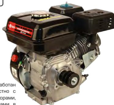
Двигатель бензиновый разработан специально для использования совместно с генераторами, мотоблоками, культиваторами, мотопомпами и различными устройствами в быту. Тип двигателя: бензиновый, 4-х тактный, одноцилиндровый, с воздушным охлаждением и верхним расположением клапанов. В качестве топлива для данной модели рекомендовано использование бензина марки АИ-92 (неэтилированного).
