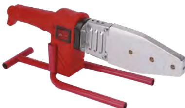
**Сварка** полипропиленовых, ПВХ, ПНД труб и фитингов методом раструбной (муфтовой) сварки в бытовых условиях. Сварка производится путем нагрева деталей до температуры плавления и последующего остывания
