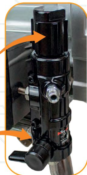
Поворотный сифон с металлическими всасывающей и дренажной трубками
