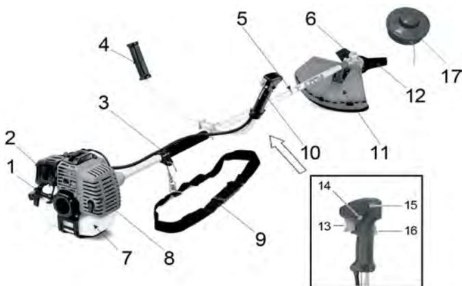
1) рукоятка стартера; 2) рычаг управления воздушной заслонкой; 3) скоба крепления ремня; 4) левая рукоятка; 5) штанга; 6) нижний редуктор; 7) топливный бак; 8) глушитель; 9) плечевой ремень; 10) рукоятка управления; 11) защитный кожух; 12) режущий нож; 13) курок управления дроссельной заслонкой; 14) фиксатор курка управления; 15) выключатель зажигания; 16) блокиратор случайного пуска; 17) катушка с леской
