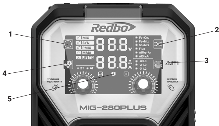
1 - выбор режима сварки; 2 - кнопка выбора использования проволоки в среде газа/без газа; 3 - кнопка выбора диаметра проволоки; 4 - выбор функции 2T/4T; 5 - индикатор термозащиты рис.1б
