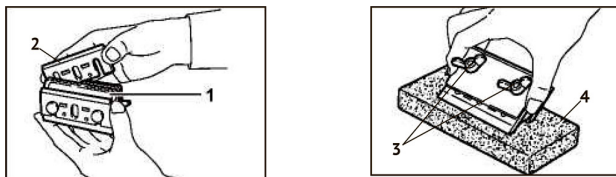
1 - держатель ножа; 2 - нож; 3 - гайки крепления; 4 - брусок
