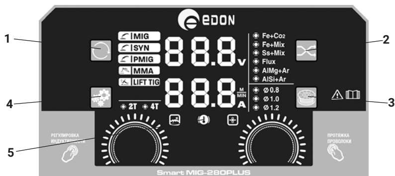
1 - выбор режима сварки; 2 - кнопка выбора использования проволоки в среде газа/без газа; 3 - кнопка выбора диаметра проволоки; 4 - выбор функции 2Т/4Т; 5 - индикатор термозащиты рис.1б
